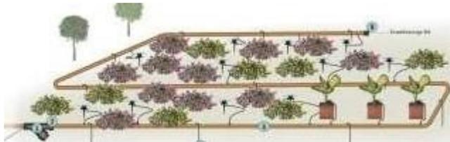
Ratsam ist hier die Verwendung eines Druckminderers mit integriertem Filter, damit keine Unreinheiten die feinen Düsen verstopfen. Der Filter muss dann regelmäßig gereinigt werden.
